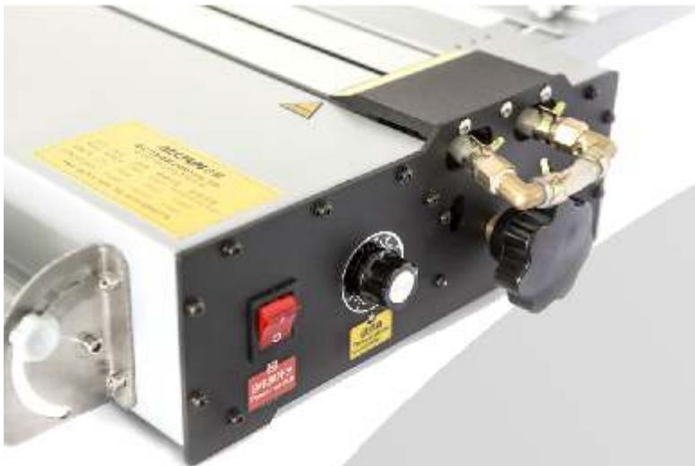
Regolazione manuale della temperatura da 0 a 600°C
