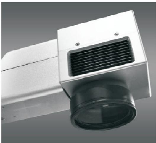
Il raggio laser è direzionato da un sistema a due specchi che ruotano rapidamente (tecnica galvo) all'interno della testa sopra la lente. Ciò permette un'elevata velocità di marcatura, molto più veloce rispetto ai tradizionali plotter laser.
