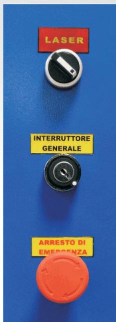
L'accensione e lo spegnimento della macchina possono essere effettuati solamente attraverso un'apposita chiave di sicurezza sul quadro di comando.
