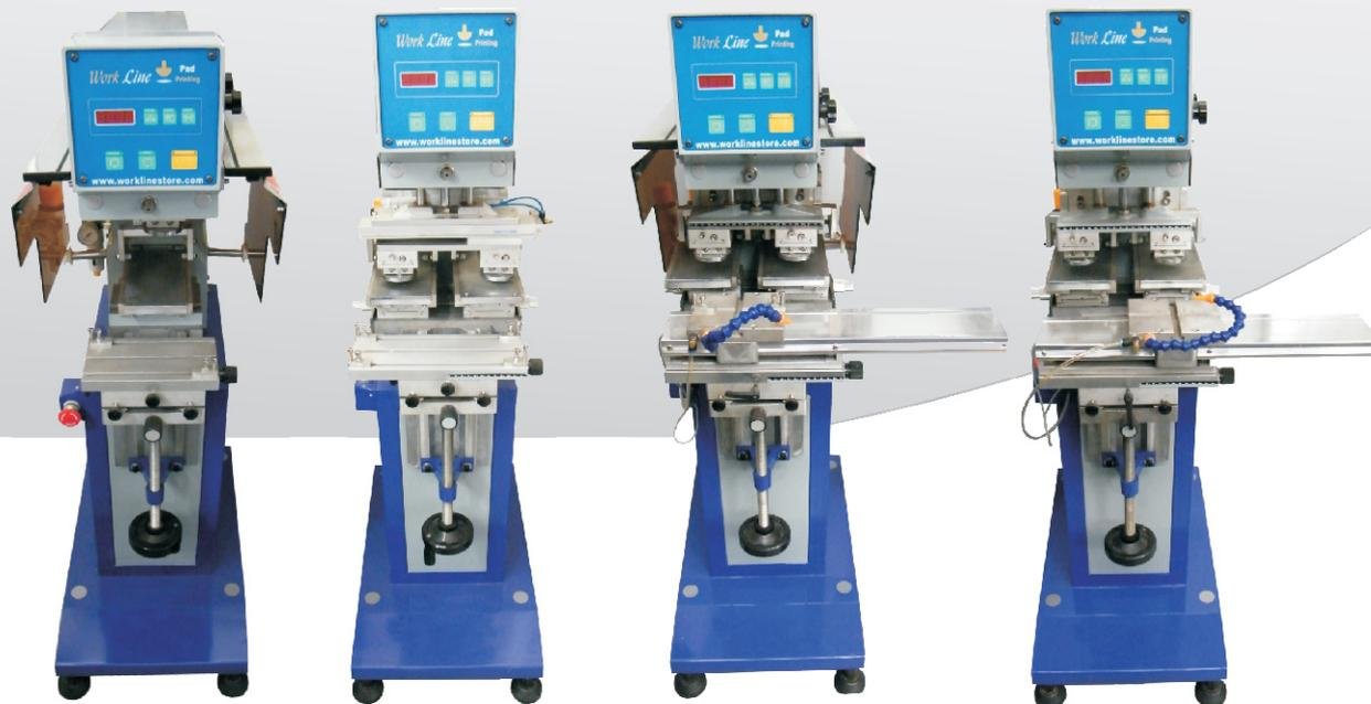
Macchine tampografiche pneumatiche con base professionale a 1,2 o 4 colori con base shuttle. Hanno un sistema di blocco meccanico per lo scorrimento verticale del tampone, in modo da ottenere la massima precisione possibile. L'inchiostro è contenuto in una tazza che adotta un sistema avanzato per la tutela dell'ambiente e per il risparmio di inchiostro.
